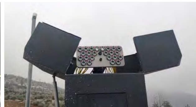
▲ 我国首台智能红外风机融冰设备在江西蜈蚣山风电场成功试运
