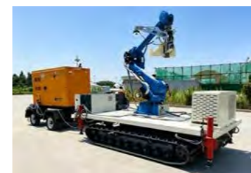
▲ 环境公司针对退役风电叶片回收世界性难题，开发出可适应野外分散及集中作业的“移动式环保智能切割机器人”
